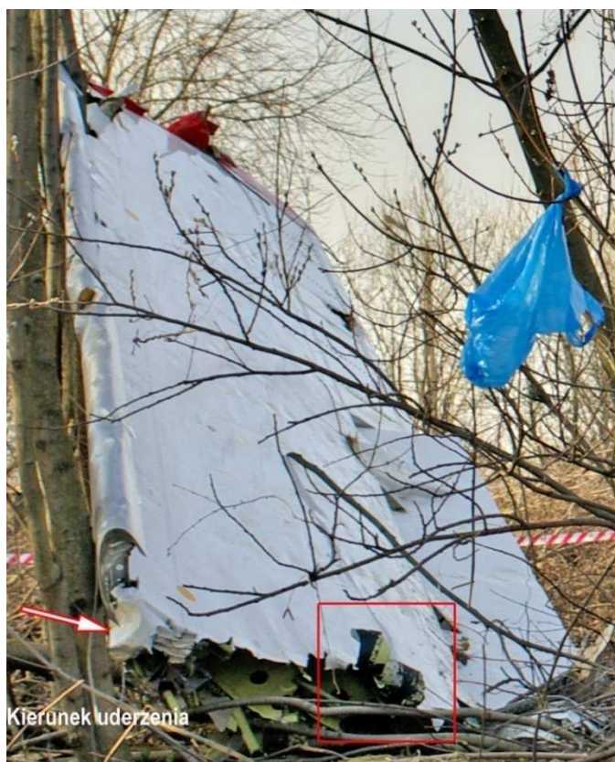
Rys. 12. Końcowa część lewego skrzydła. (Widać spodnią powierzchnię).
