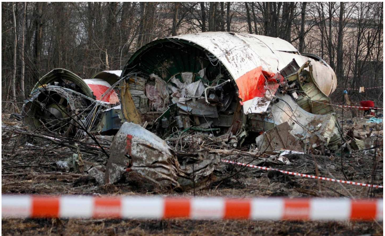
Rys. 23. Stan zniszczenia wręgi ogonowej, zamykającej tylną część kadłuba.
