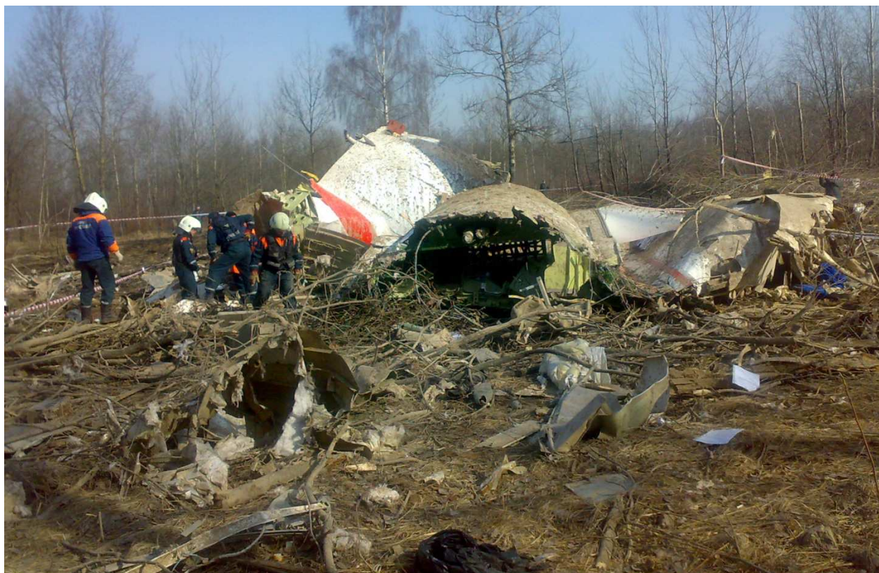
Rys. 7. Główna, pasażerska część kadłuba, rozerwana i odwrócona spodem do góry. Po lewej i prawej stronie wydmuchniętej części pasażerskiej kadłuba widać wywinięte na zewnątrz burty, a po prawej stronie część sufitu samolotu.
