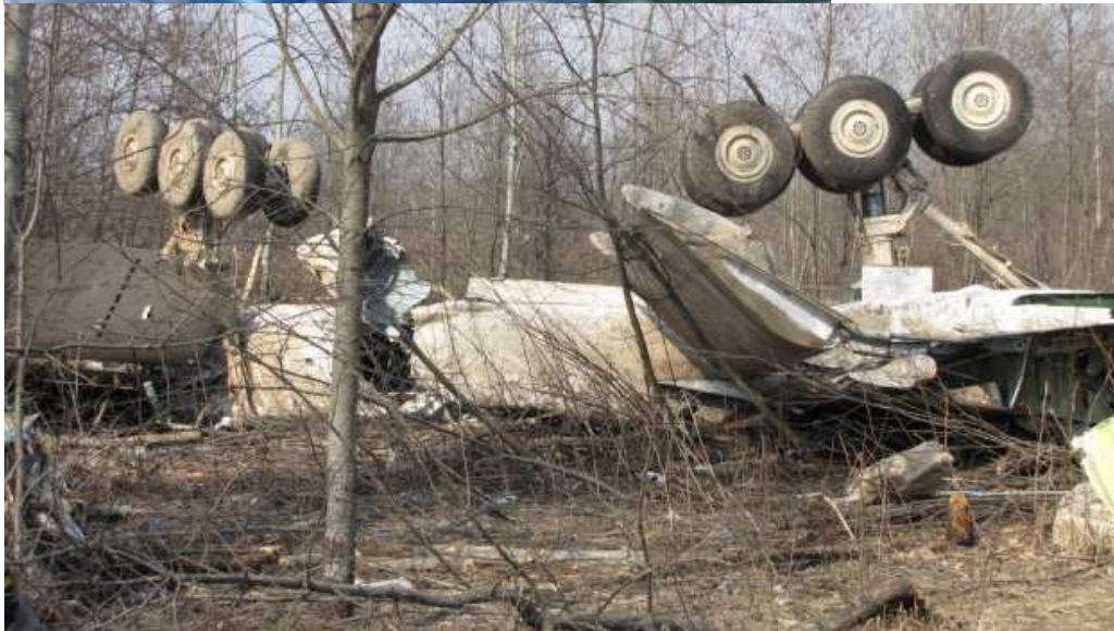
Rys. 9. Tylna część kadłuba i skrzydła, które wylądowały odwrócone.
