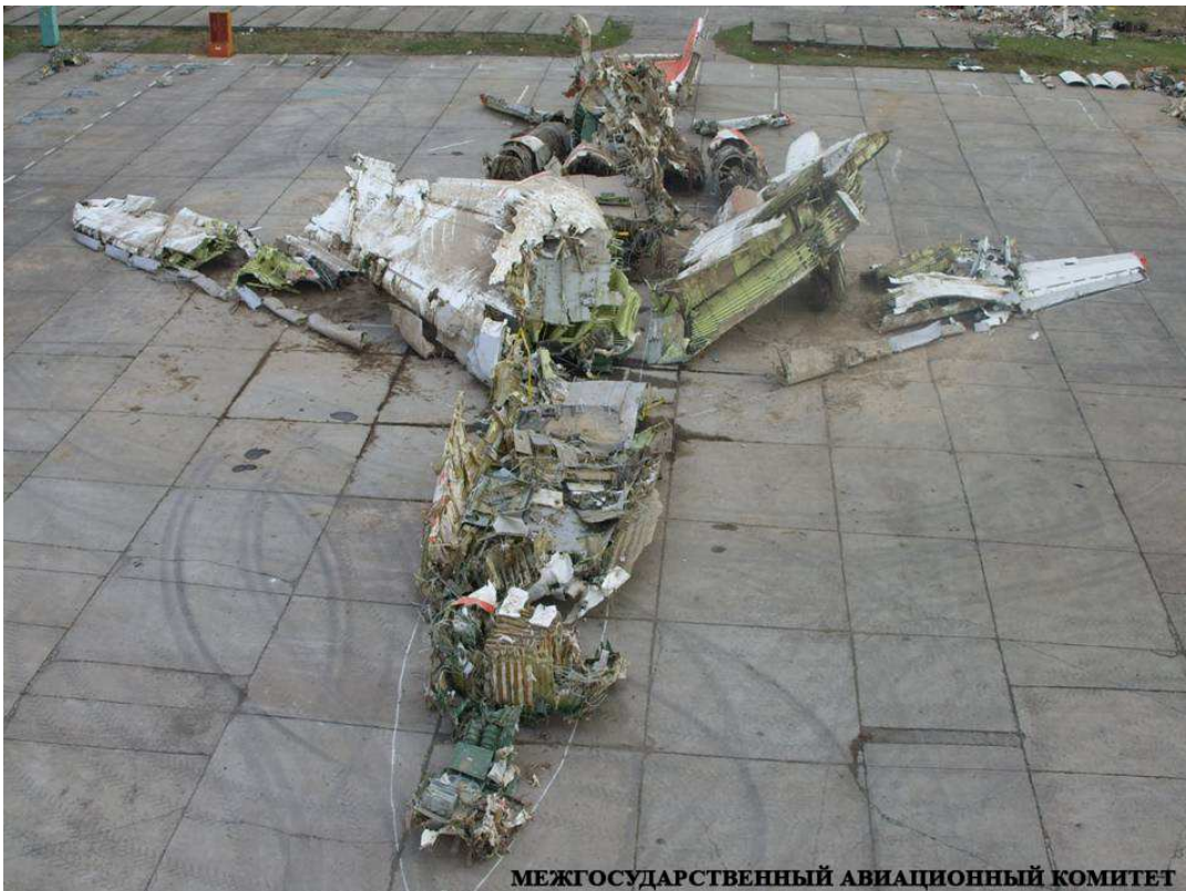
Rys. 4. Wrak samolotu zestawiony na lotnisku i widziany od przodu. Po prawej stronie widać resztki lewego skrzydła. Wygląda na to, że nie ma ono wyraźnej łączności z resztą centroplata.
